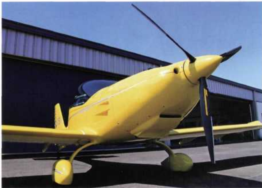
Schnittiger: Der flache Kühlluft-Einlauf ist getrennt von der Cowling am Rumpf montiert
