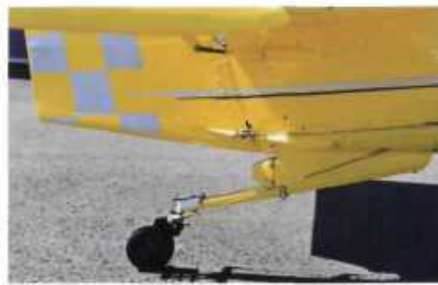
Gedämpfte Spornradsteuerung: Die langen Seile wirken wie eine leichte Entkopplung
