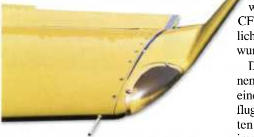
Neu: trapezförmiger Außenflügel mit flachem Winglet und Platz für Positionsleuchten
