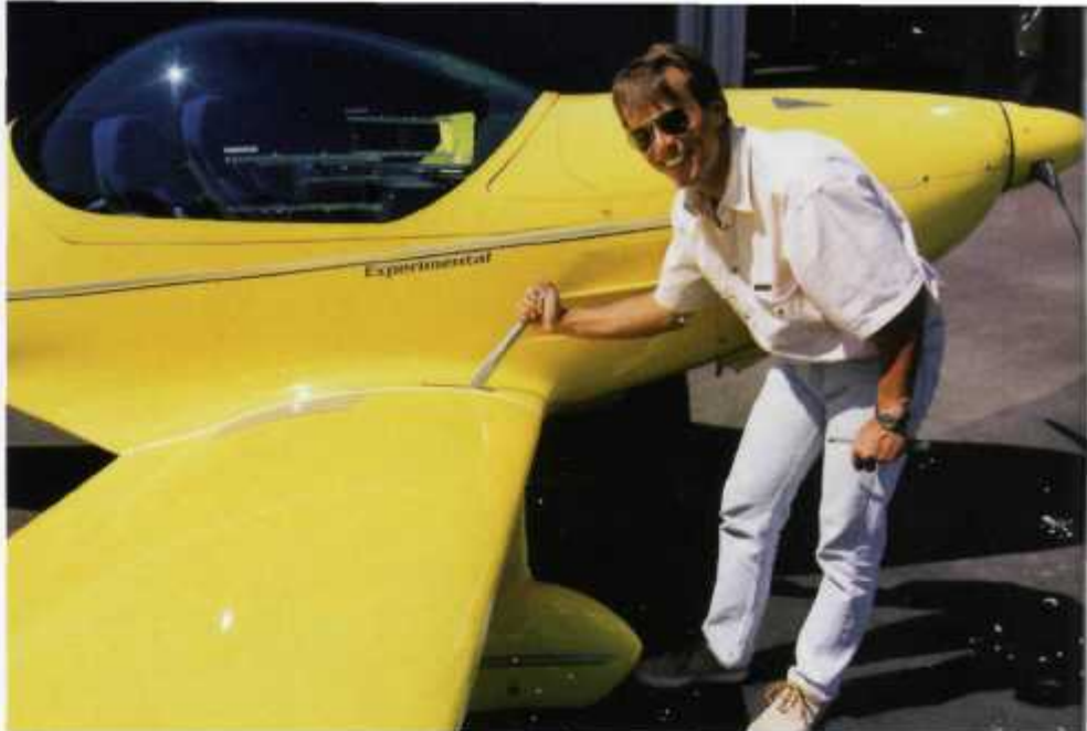
Hier hebt der Chef: Zur Demontage der Flügelhälften betätigt Peter Funk die Entriegelung
