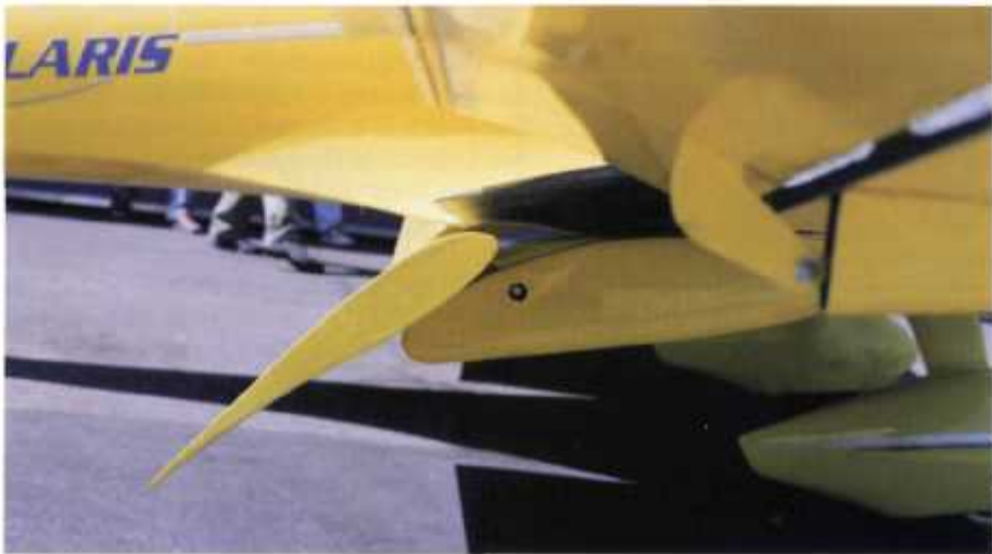
Fowler für den Langsamflug: In Endstellung ist die Flügelfläche um 20 Prozent vergrößert
