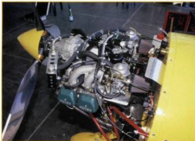
DIE MOTORINSTALLATION ist tadellos. Konstrukteur Peter Funk verzichtet auf eine Airbox.
