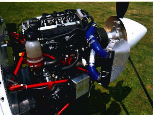
Drei Zylinder und wenig Verbrauch: Der smart-Diesel soll neuen Schwung in den Markt der UL-Motoren bringen.
