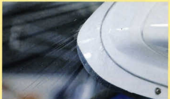
DIE LEXAN-SCHEIBE ist preiswert, aber nicht sonderlich langlebig. Sie neigt zu Rissen im Bereich der Flügelwurzel.
