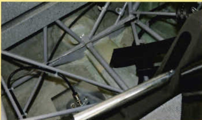
LEICHT ZU KONTROLLIEREN: Ein Blick unter die Sitzschalen offenbart Schäden im Bereich der Fahrwerksaufnahme.
