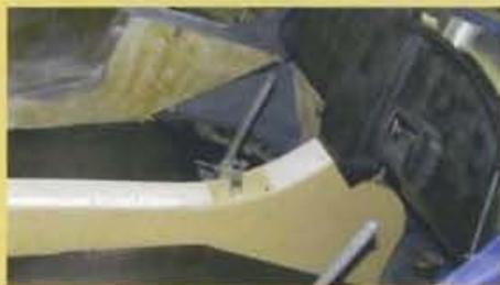
**BILDER VOM ROHBAU:** Der Bau von Tank (rechts), Panel und Mittelkonsole erfordert Erfahrung im Umgang mit Composite-Werkstoffen.
