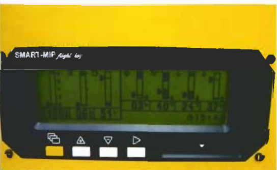
Las tres pantallas del MiP: parámetros de motor, flight-log y consumómetro.
