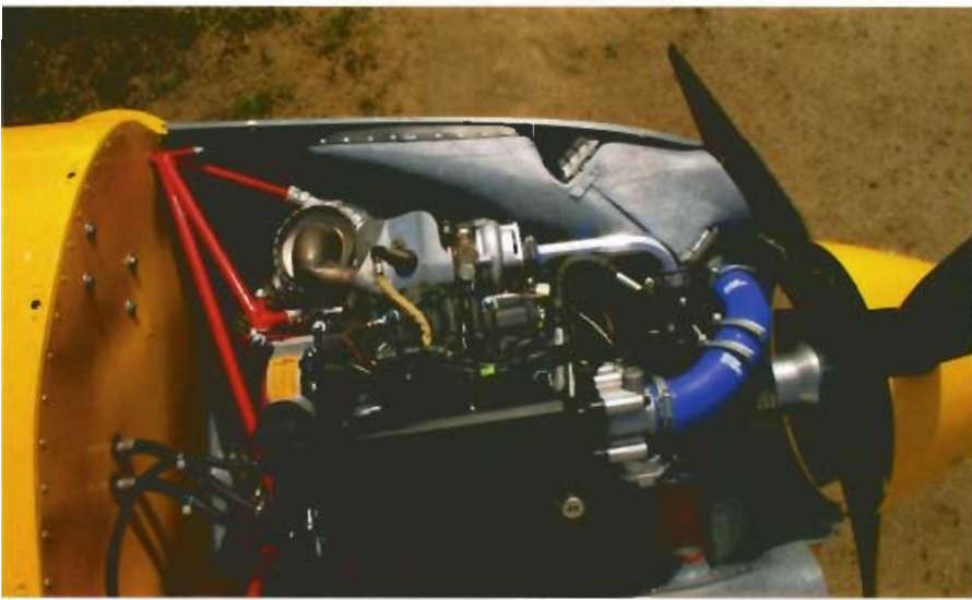
El M-160 está colocado bastante adelantado, pues es de menores dimensiones que el Rotax 912.
