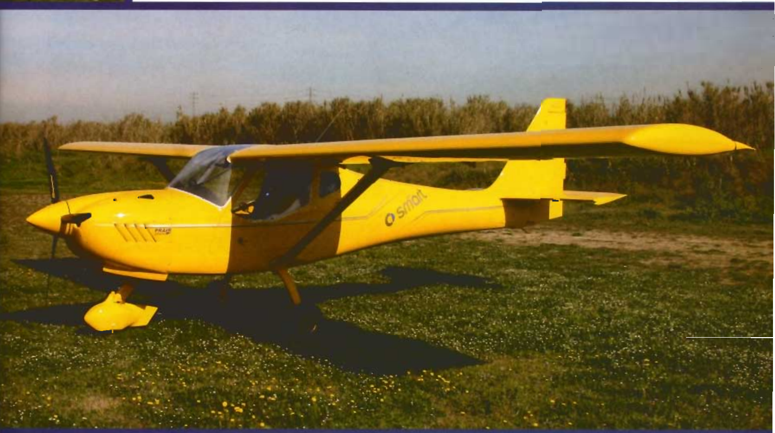
Otra diferencia menos evidente: el FK9 con Rotax equipa una tripala Junkers, mientras que el Smart lo confía a una tripala Duc.
