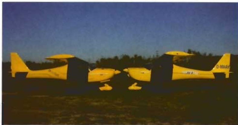
Frente a frente los dos modelos son sólo diferentes por las tomas de aire y las dimensiones del capó.
